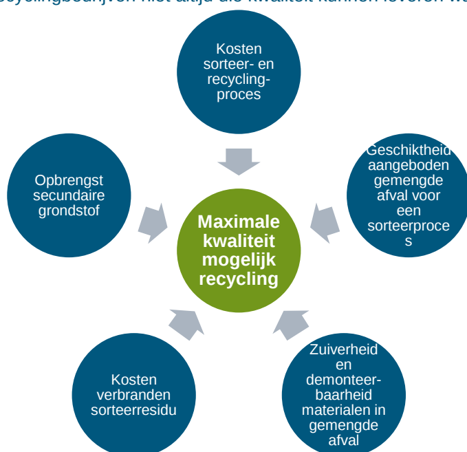
Figuur 1 Factoren van invloed op maximale kwaliteit voor secundaire grondstoffen
